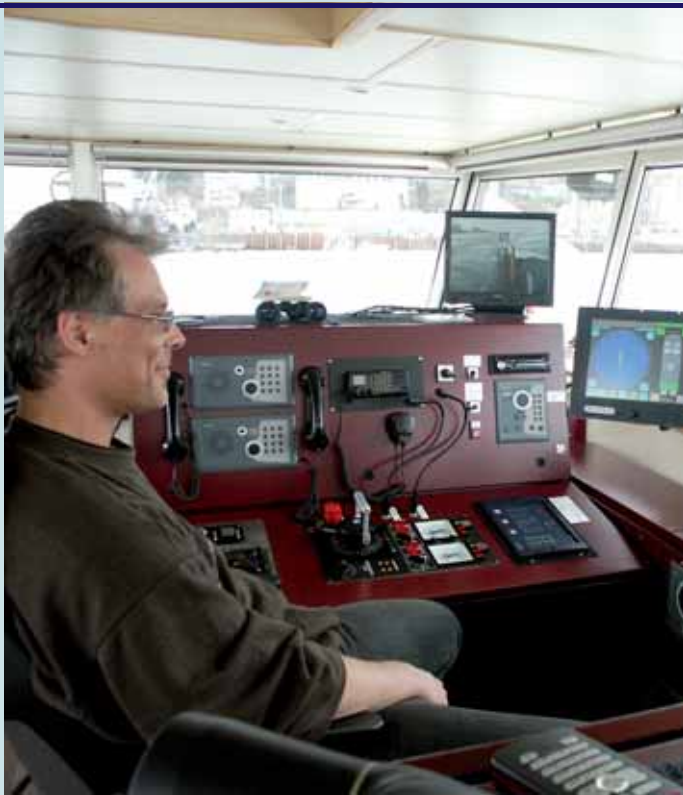
Fünf Steuermöglichkeiten stehen Schiffsführer André Borkenhagen auf dem Futura Carrier zur Verfügung. Dazu zählen Autopilot, Rechnergestützter Joystick-Betrieb, Handles am Steuerstand, Notsteuerung von der Brücke aus sowie Handbetrieb der Maschinen.
