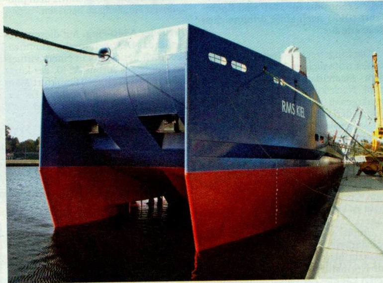
Von vorn ist die neuartige Bugform der „RMS Kiel“ gut zu erkennen.
