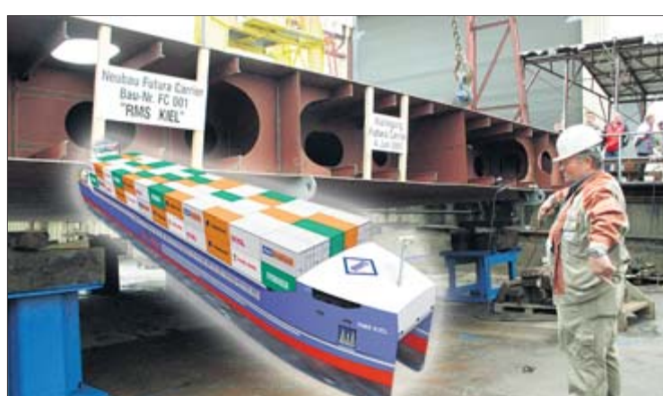
Die Kielsektion des neuen Typs – hier in der Fotomontage auch als Modell des katamaran-ähnlichen Schiffs zu sehen – wurde vorsichtig auf der Con-Mar-Werft in Brake auf die Pallen dirigiert. Montage: Palinski
